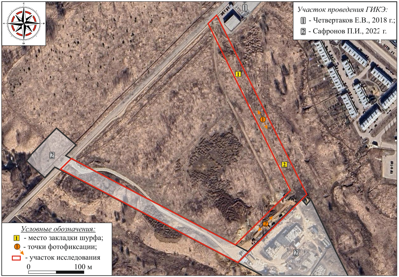
Илл. 8. Нижегородская область, г. Нижний Новгород, Новинский сельсовет, строительство а/д по ул. Минина и ул. Деловая - 2026 г. Космоснимок с нанесением участка исследования и расположением шурфов (источник космоснимка: google.ru, дата съемки 2025 г.).
